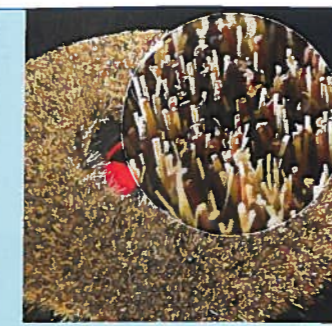
Polierbürste als Teller-beziehungsweise Scheibenbürste. Sie hat mittelharte Borsten – meist pflanzliche und tierische – und dient zum Polieren von Pflegefilmen.
