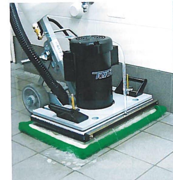
Die besten Ergebnisse werden auf strukturierten Belägen und Mörtelfugen mit oszillierenden Scheueraggregaten oder Exzentrerscheueraggregaten in Verbindung mit Scheuerbürsten/Borstenpads erzielt.
